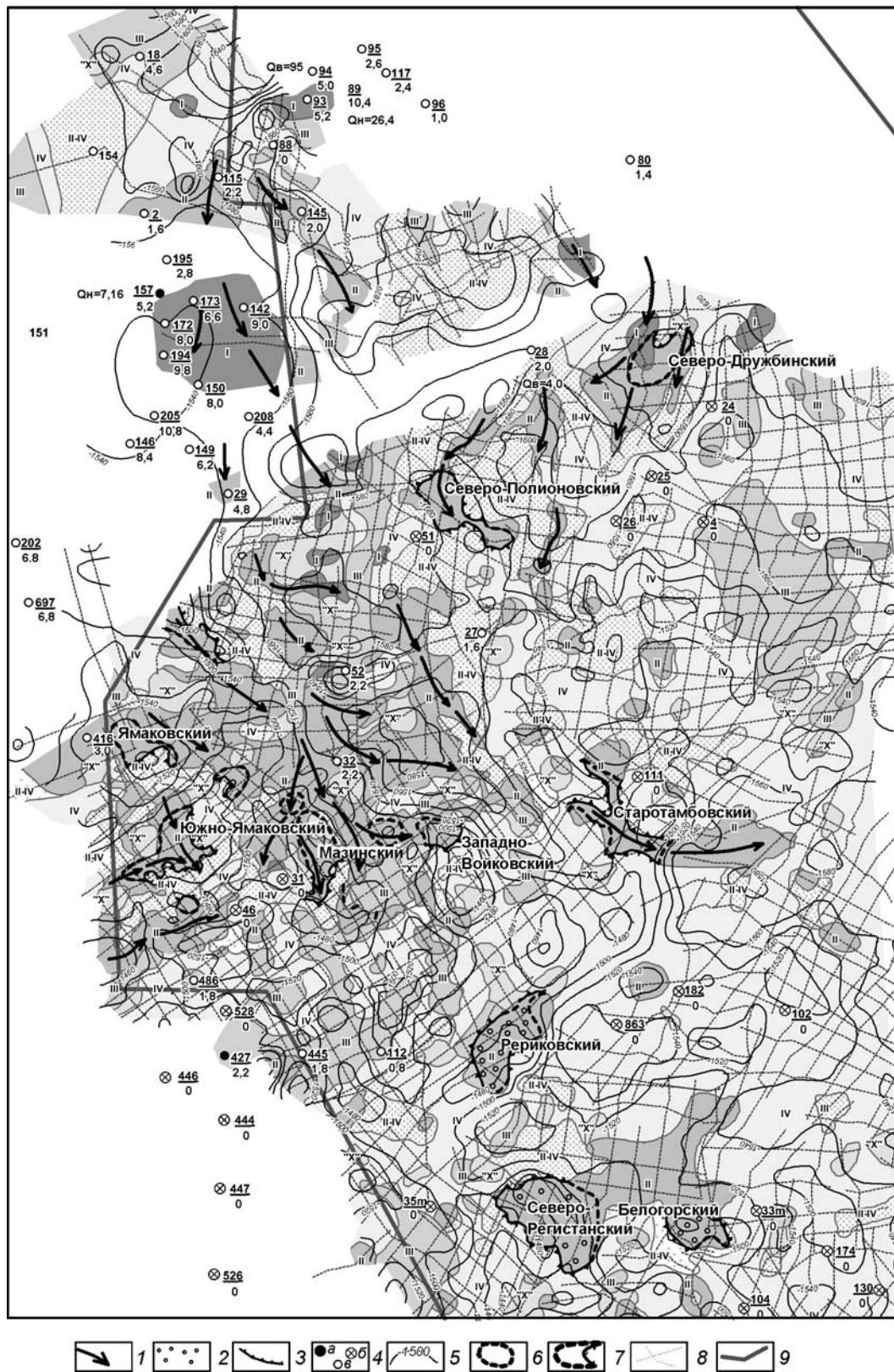
**Рис. 3. Прогноз размещения ловушек в пласте  $D_0$  на основе карты типов разреза кыновского горизонта по данным факторного анализа спектрально-временных параметров и палеогеографических данных:**
