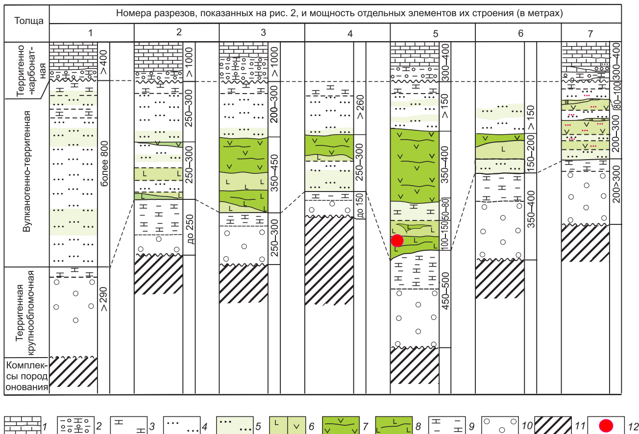
Рис. 3. Положение вулканогенных отложений в разрезе раннекаменноугольного вулканогенно-терригенно-карбонатного комплекса Миндякской грабен-синклинали. При составлении использовались данные ГДП-50 (Ш. Н. Кац и др., 1980), поисковых работ (В. В. Кандыба, Н. А. Швалев и др., 1981; Г. А. Морозов и др., 1992; В. Ф. Созинов и др., 1993) и исследований ЦНИГРИ разных лет:
