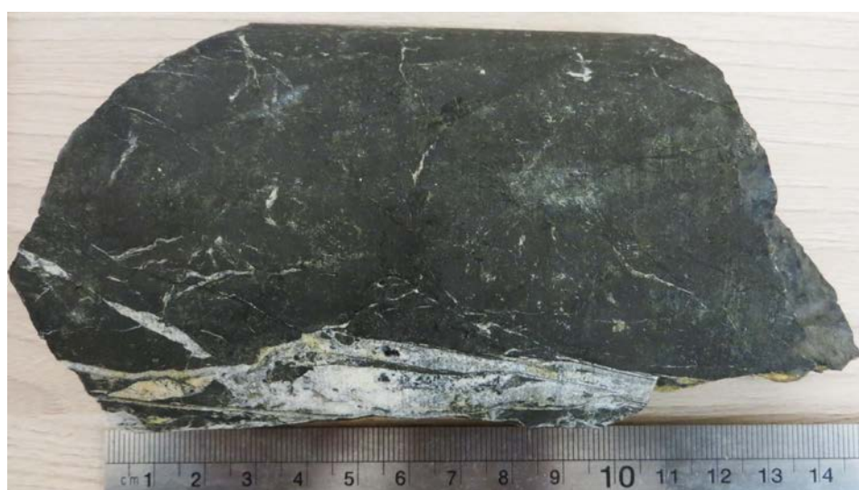
Рисунок 3.17 — Золотоносные сплошные магнетитовые руды месторождения Новогоднее-Монто с гнездами и прожилками кальцита, скарновых минералов (фрагменты керна из коллекции автора)
