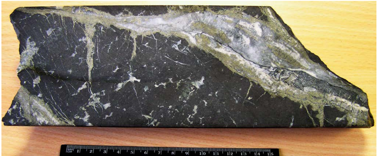
Рисунок 3.16 — Золотоносная магнетитовая руда месторождения Новогоднее-Монто с кварц-кальцит-сульфидными гнездами и прожилками (спил фрагмента керна из коллекции автора)
