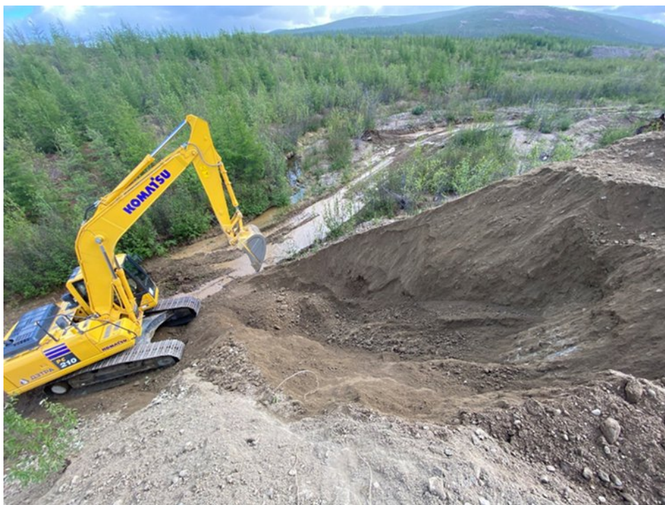
Рис. 0.12 Отбор валовой пробы экскаватором
