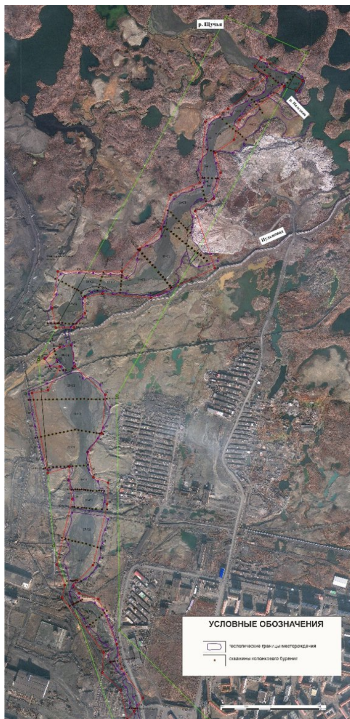
Рис. 0.10 Линии колонкового бурения в пределах аллювиально-техногенной россыпи (Уютов; 2017)
