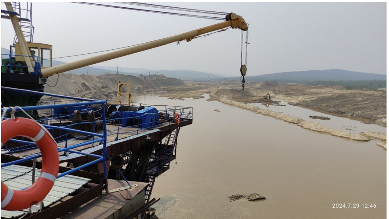
Рис. 0.8 Подготовленный ход драги по техногенным образованиям со снятой вскрышей (р. Уркима, 2024)
