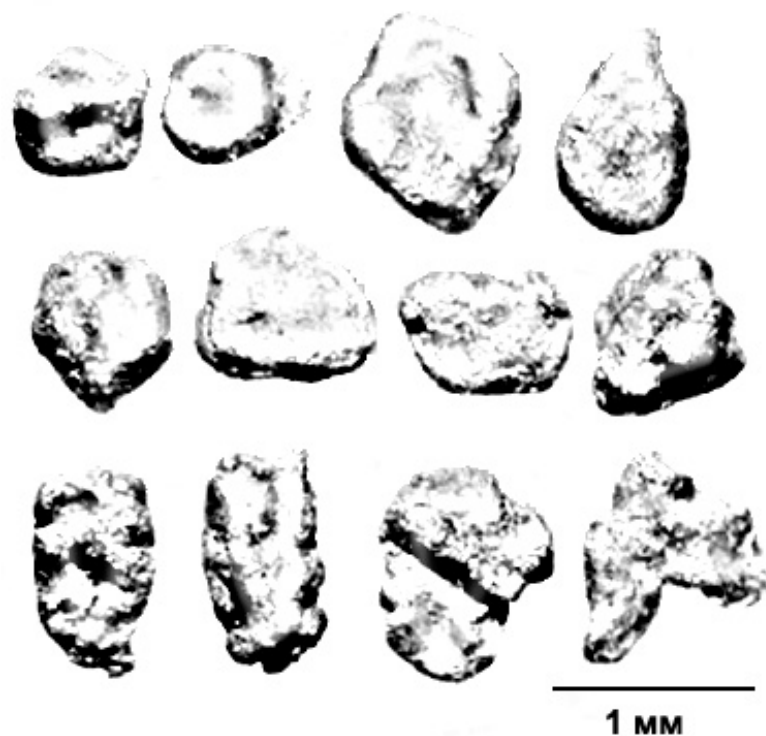
Рис. 2.12 Уплощенные кристаллы, их сростки и гемиидиоморфные золотины с амальгамацией поверхности разной интенсивности
