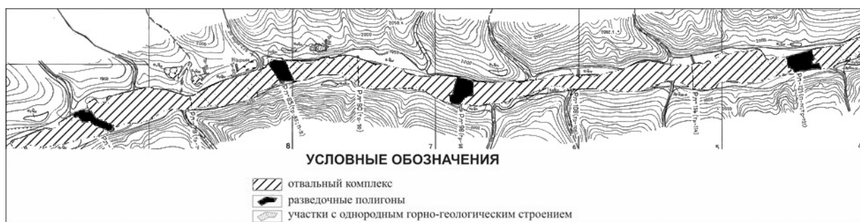
Рис. 2.3 Разведка отвалного комплекса ТР горно-разведочными выработками (полигонами) с использованием материалов Добрянского Г.И. (2000)
