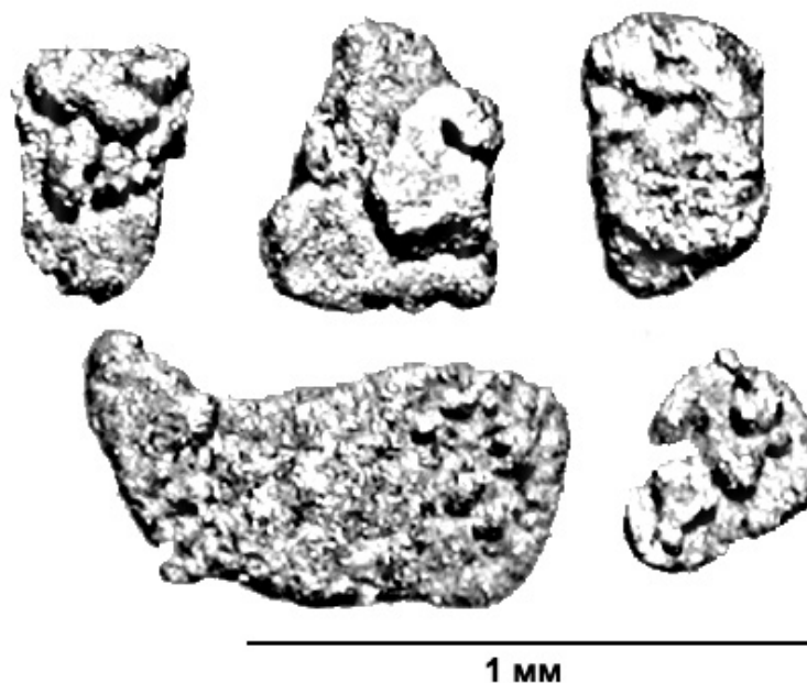
Рис. 2.13 Слипание золотин в результате амальгамации
