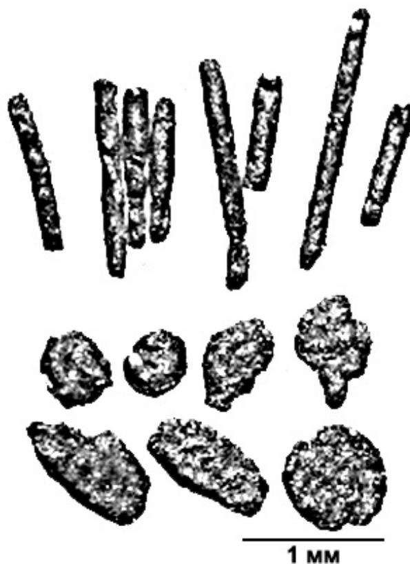
Рис. 2.11 Палочковидные заваляцованные, пластинчатые и лепешковидные золотины с тонкогубчатой поверхностью
