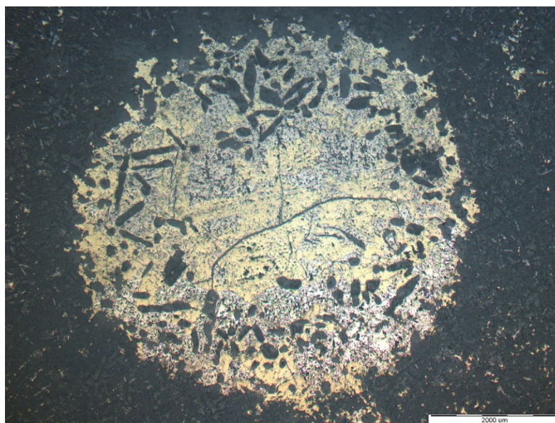
Рис. 1. Внешний вид сульфидных обособлений в ивакинской свите. Фото в отраженном свете. Темные вытянутые выделения – включения в сульфидных обособлениях.
