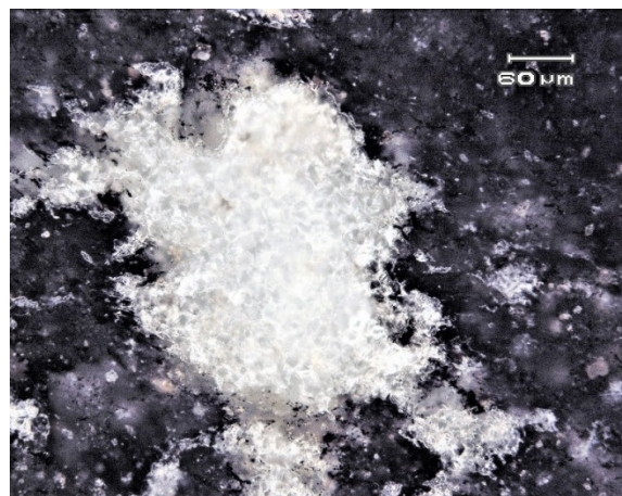
Рис. 3 Пятна раскристаллизованного накрита белого цвета в центральной части гидротермально-бактериальной постройки.
