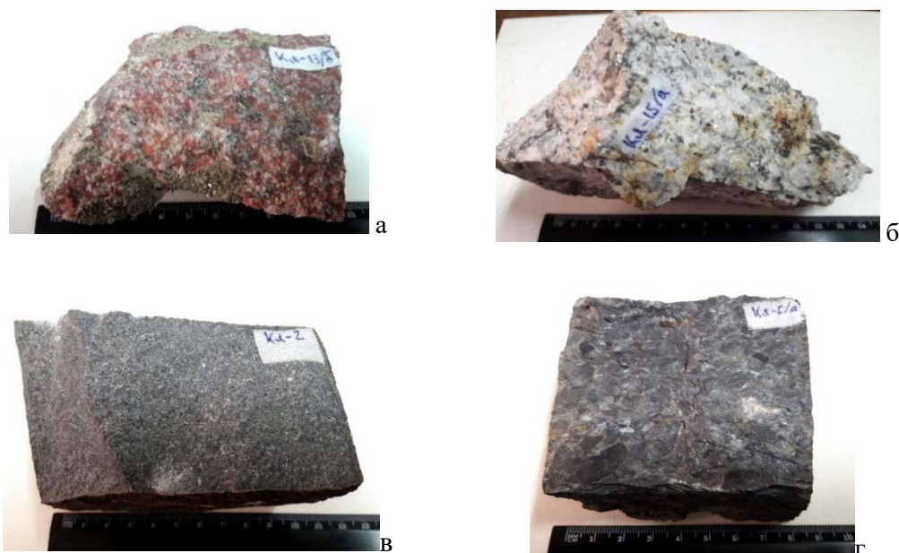
Рис. 2 Мусковитизированный крупнозернистый гранит (а), мусковитизированный мелкозернистый гранит (б), мелкозернистый аркозовый песчаник (в) и глинистый углеродсодержащий сланец (г).
