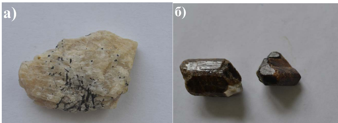
Рис. 3 Главные рудные минералы месторождения Чердоjak (а) шеелит с игольчатым турмалином (шерлом); б) кристаллы касситерита темно-коричневого цвета).
