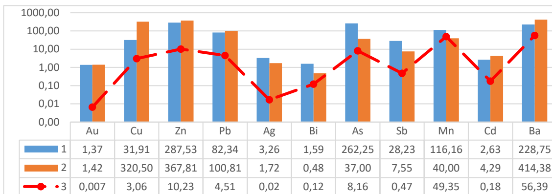
Рис. 2 Соотношение средних содержаний геохимических элементов в послойной вкрапленной золото-сульфидной минерализации (1), секущей прожилково-вкрапленной золото-кварц-сульфидной минерализации (2) и в малоизмененных рудовмещающих вулканогенных риолитах (3).
