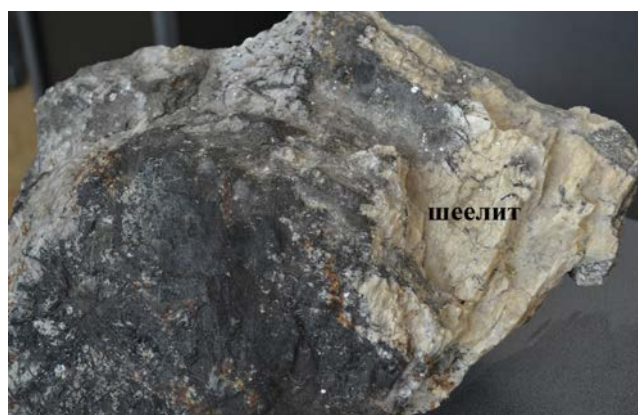
Рис. 2 Рудоносный грейзен кварц-графит-турмалин-касситерит-шеелитового состава.
