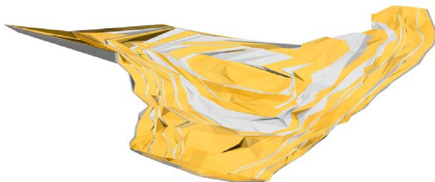
Рис. 2 Визуализация литологических разностей участка Талдинского месторождения (все пласты окрашены в серый цвет, а пропластья и сочетания аргиллитов, алевролитов и песчаников - в оранжевый)
