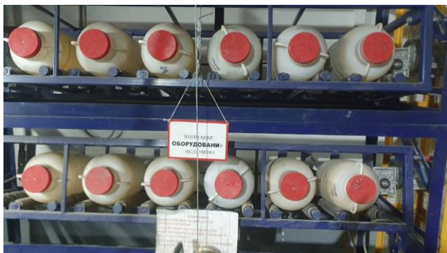
Рис. 1. Внешний вид агитатора для проведения статико-агитационного выщелачивания (HLA-тестов)
